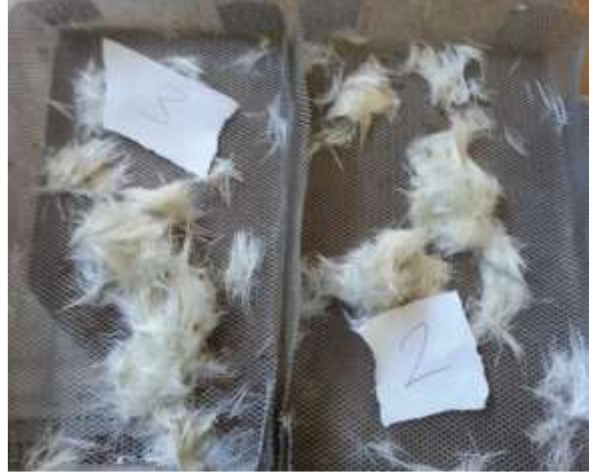
Şekil 1a-b: Yıkama deneyinde kesilmiş numune ve elek üzerindeki lif miktarı
